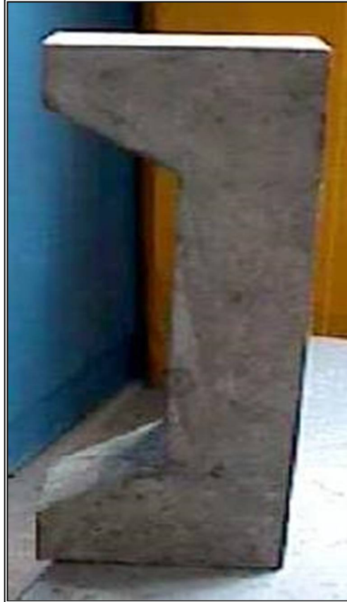
Figura 2.6 Columna de concreto reforzado con ménsulas en sus extremos, para la aplicación de la carga excéntrica.
