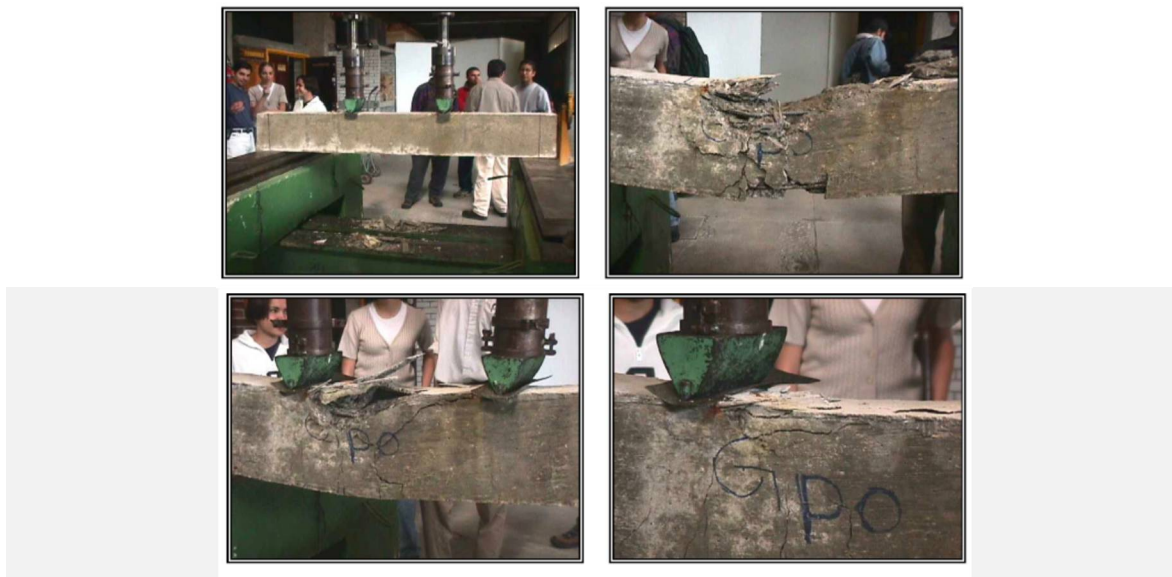
Fig. 1.10 Ensayo de viga con falla a compresión.
